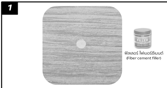
เก็บงานหัวตะปูเกลียวด้วยฟิลเลอร์ ไฟเบอร์ซีเมนต์ (Fiber cement filler) ปล่อยให้แห้งสนิท
